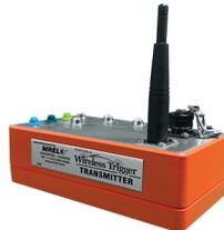
O **Blaster's PWT™** Portable Wireless Trigger é um Acionador Portátil Wireless que permite aos operadores enviarem um sinal para as câmeras ou outros instrumentos de forma remota a uma distância segura, sem necessidade de utilizar longos fios para acionamento. Desta forma, permite que o operador posicione uma ou mais câmeras mais próximas da detonação do que seria considerado seguro para uma pessoa e então acioná-las remotamente a uma distância de até 500 m.
